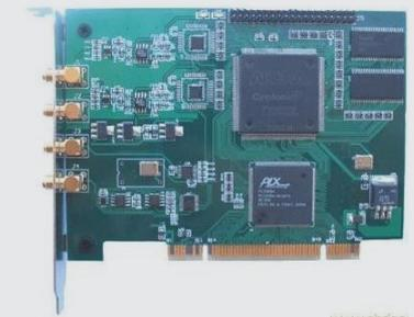
Hummable 推出的 PCI/PXI 高速数据采集卡是针对高速高精度测试应用的理想产品。我们为客户提供多种高精度、高采样率的高速数据采集卡，最高采样率可达到 1.6Gsp/s，AD 精度从 12~16Bit 可选，满足多种应用场合的需求。
